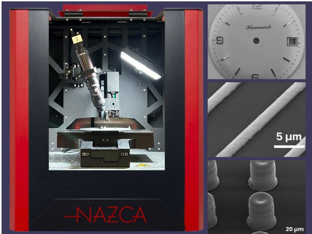
*La Nazca est une imprimante 3D produite par Hummink. Elle utilise la technologie de Dépôt de liquide pour produire des pièces en or, argent, élastomères, bio/organiques et Électroniques à partir de matériaux sous forme de liquide.*
