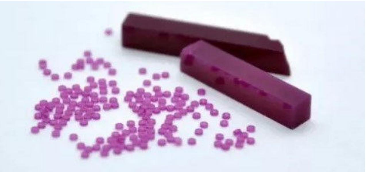
Pour les pierres d'horlogerie, le rubis polycristallin proposé par Nanoe est un matériau de choix. Les poudres étant très fines, elles permettent de produire des paliers denses et ayant un coefficient de frottement très bas. Ainsi, en fluidifiant le mouvement des aiguilles, les mécanismes consomment moins d'énergie et gagnent en autonomie.
