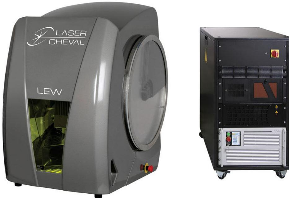
***Machine compacte LEW : Ce poste de soudage laser compact peut intégrer une source laser fibrée de 150W en pulsé ou 250W en continu. Il permet de faire de la microsoudure en point par point ou par cordon.***
