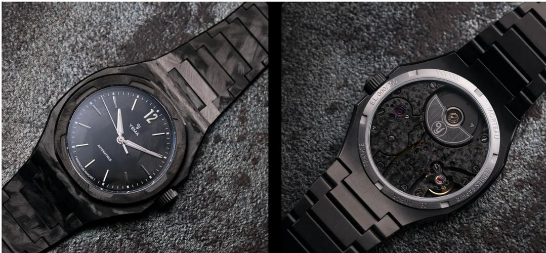
Le fond du boîtier présente un fond transparent en saphir qui permet d'admirer le calibre Manufacture CMM.20 et sa décoration unique dans toute sa splendeur ainsi que de préserver une étanchéité de 100 mètres. Calibre à micro-rotor ultrafin offrant une précision quasi chronométrique et une réserve de marche de 70 heures tout en battant à 28 800 Alternances par heure (4 Hz).
